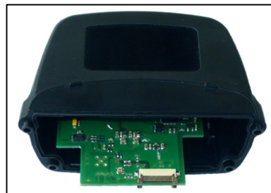
Erweiterte Abdeckung mit integrierter RFID Platine
